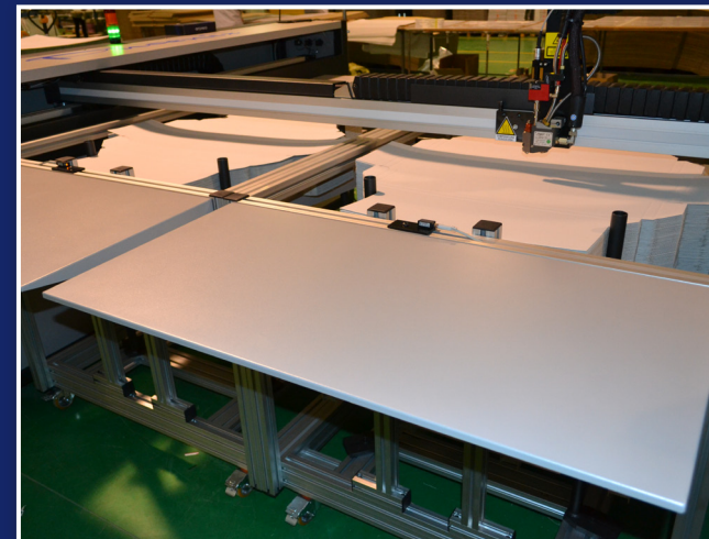
Alte Pile indipendenti di varie dimensioni, Altezza carico Max 700mm, possibilità di lavorare singolarmente o contemporaneamente per grandi formati.
